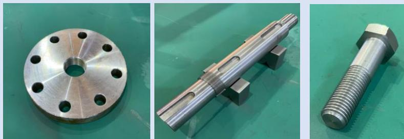
製作実績 : フランジ穴あけ/タップ加工、シャフト製作、六角ボルト製作、ネジ加工、他
